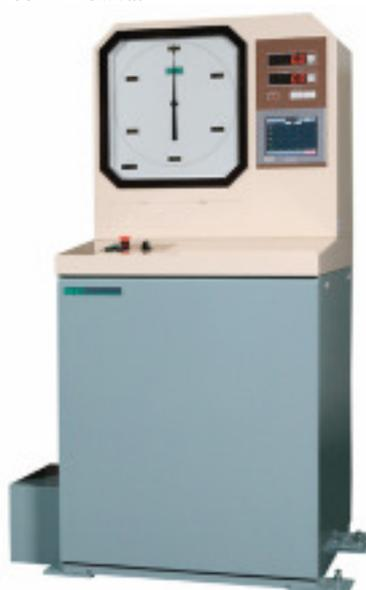
負荷力表示はアナログとデジタルを装備し、大型LCD表示で正確な読取りが出来ます。アナログ指針と負荷力デジタル表示器の表示が同期しており、電源投入時のアナログ指針のズレがありません。デジタル表示器(負荷力・最大負荷力・ラムストローク)の表示値がワンタッチでゼロリセットできます。試験力レンジは6段切換えとし広範囲な計測を可能にしております。また、切換えも手動と自動の両機能を装備しておりますので、試験作業の効率化がはかれます。なお、データ処理装置(オプション)への接続も可能です。
